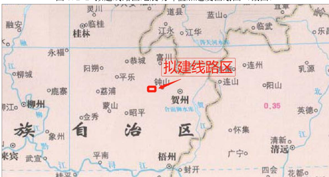
图 3.2-3 拟建线路区地震动反应谱特征周期区划图（截图）
