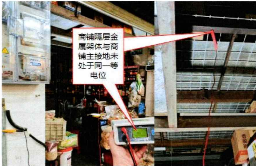
图三十 商铺隔层金属架体与商铺主接地等电位测试图 拍摄单位：公明街道办事处 拍摄时间：2023年7月29日
