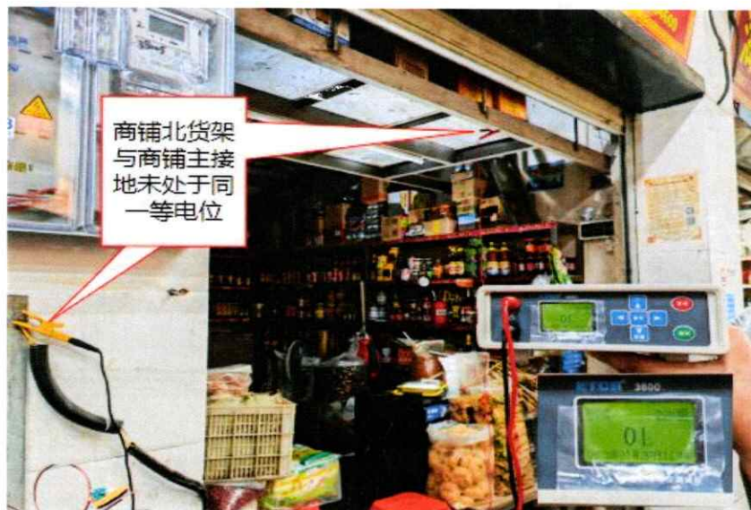
图二十九 商铺北货架和商铺隔层金属架体等电位测试图
