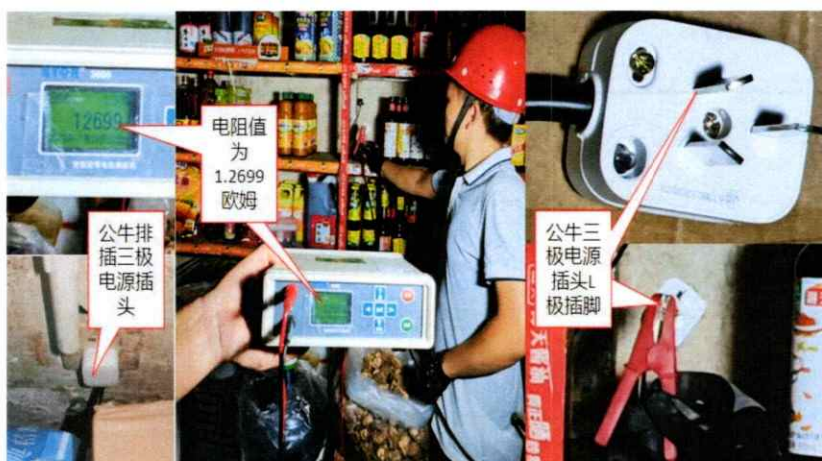
图二十 公牛排插三级电源插头L极插脚与电冰柜金属外壳导通情况测试图 拍摄单位：公明街道办事处 拍摄时间：2023年7月29日
