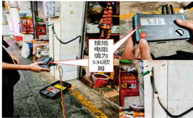
图二十八 主接地电阻检测图
