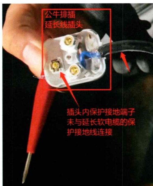
图十七 公牛排插延长线插头勘查图
