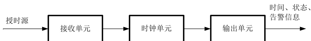
图 2.14 时间同步装置的基本组成
