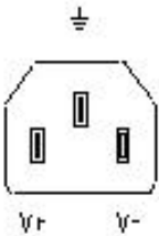
图 2.48 电源插座定义标识
