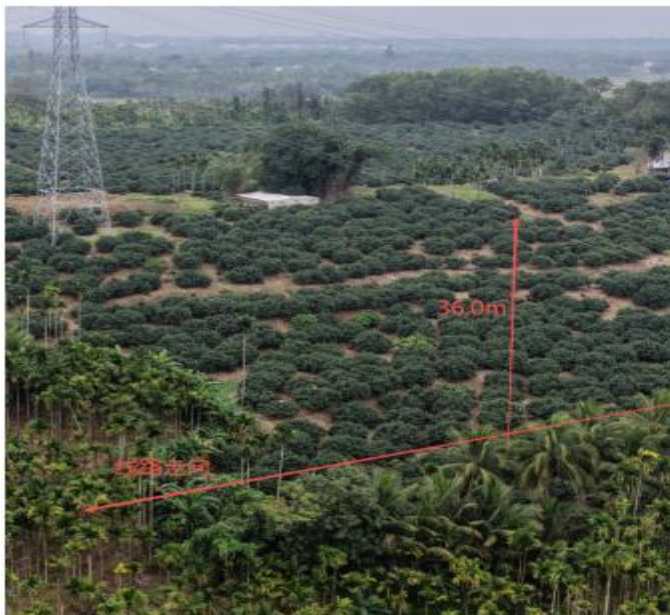
图 3.2-27 线路低穿 220kV 官塔 I/II 线穿越点
